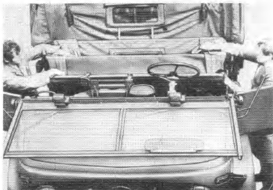
Bild 197 Verdeck an Verdeckscheren eingeschlagen
