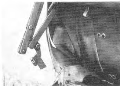
Bild 196 Untere Verdeckstütze in Fahrtrichtung ziehen
