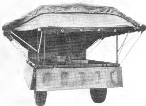
Bild 180 Stangen mit Zapfen in unterer Bohrung des senkrechten Querspiegelrohres eingeführt
